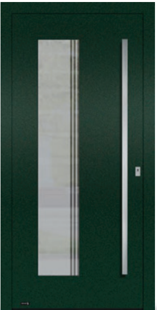
5428 Hier flügelüberdeckend mit Stoßgriff 5803.1600 dargestellt. V: VSG mattiert mit klaren Streifen O: ca. RAL 6009 Sparkling Green FSM U D : 1,1
