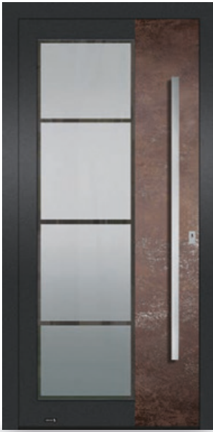
5508 Hier teilflügelüberdeckend mit Stoßgriff 5803.1400 dargestellt. V: VSG mattiert mit klarem Rand und Streifen O: Dark FSM A: Keramik Rust Oxide U b : 1,3 RC2 und RC3 optional
