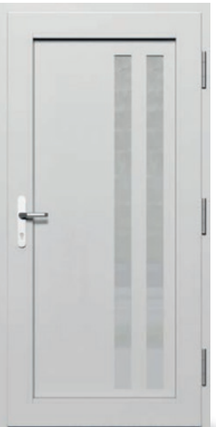
5430 Innenansicht Hier zweifarbig als FD, innen nicht flügelüberdeckend, mit Rollentürbändern und Innendrucker 5881 dargestellt. V: VSG vollflächig mattiert O: ca. RAL 9016 Verkehrsweiß U D : 1,1
